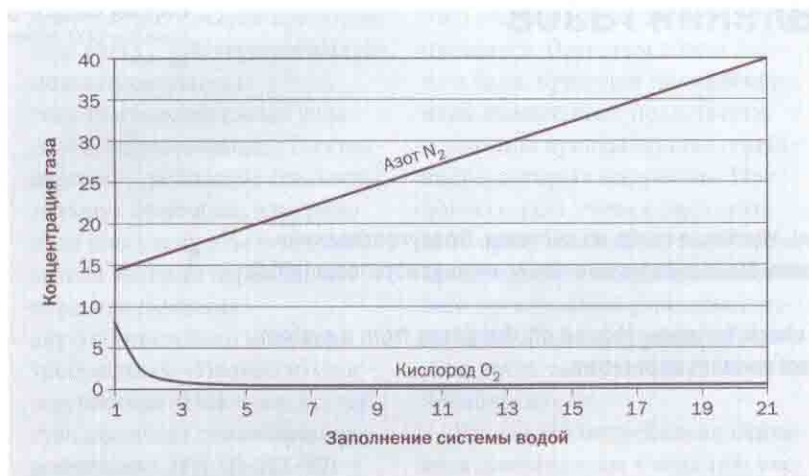
Рис. 1. Изменение концентрации азота N 2 и кислорода O 2 при заполнении системы
