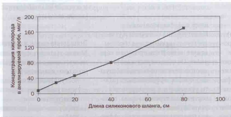
Рис. 2. Изменение концентрации кислорода в воде в зависимости от длины силиконового шланга
